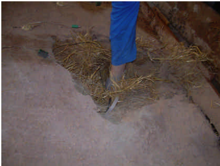
Fotografía 4: Aspecto del interior de la muestra al finalizar el ensayo.
